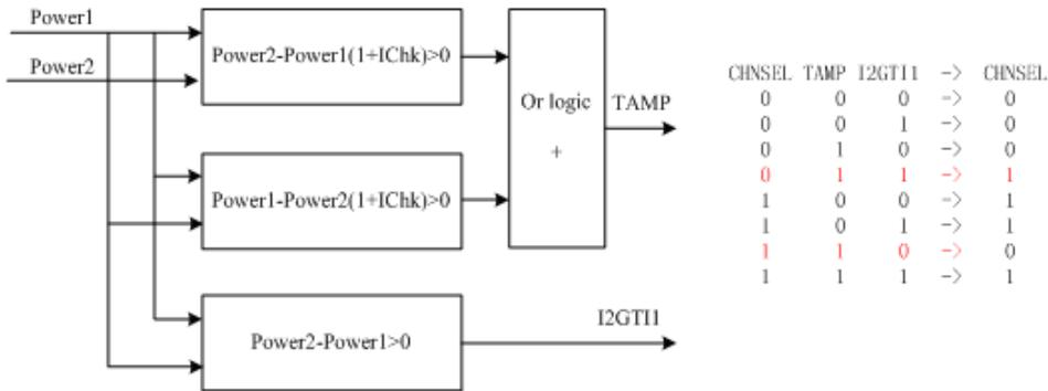
可以通过 FLTON 设置是否开启自动防窃电功能。FLTON=0 时，可以根据 CHNSEL 选择当前有效计量通道；FLTON=1 时，防窃电单元根据 IPTAMP 和 ICHK 的设置，自动选择相应的通道进行计量。
